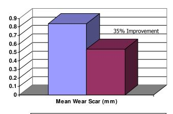
■ Isopar M ■ Isopar M + Diesel System Cleanse
